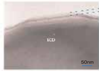
D50=3μmの粉末にAl 2 O 3 を約20nmコーティング
