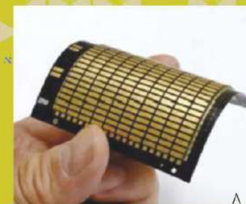
実際のフレキシブルモジュール写真 (株式会社Eサーモジェンテック様ご提供)
